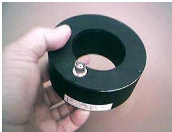
Figura 4- 3 Sensor de campo cercano en modalidad bobina de Rogowski
