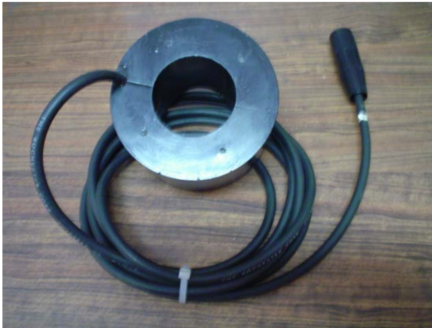
Figura 4- 18 Sensor circular encapsulado en plástico
