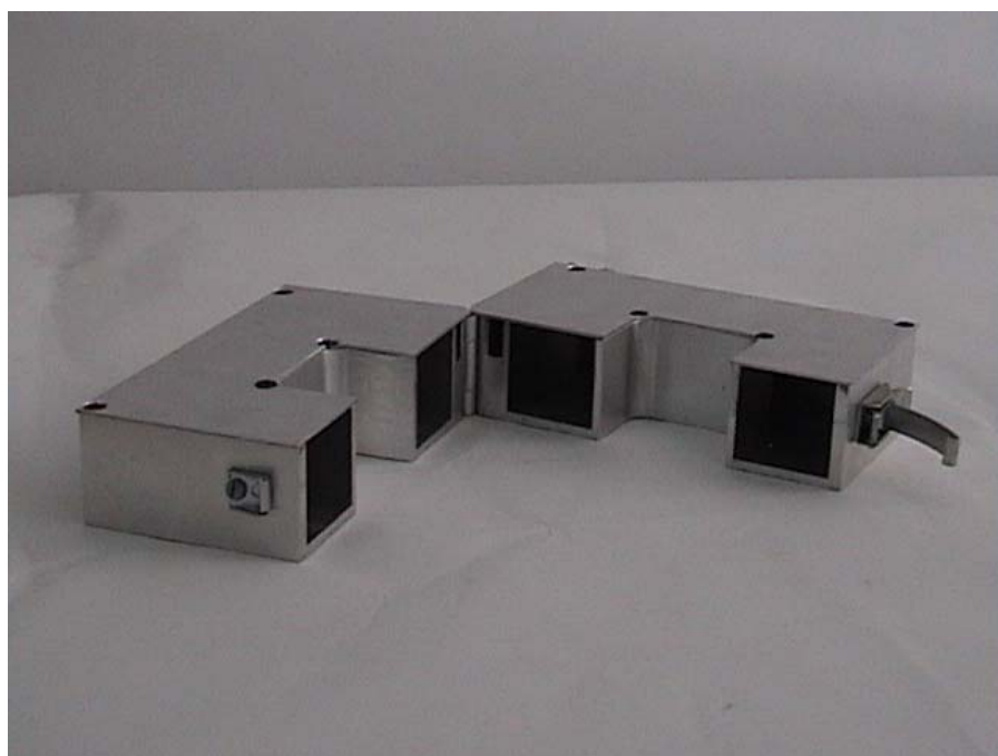
Figura 4- 22 Sensor cuadrado con abertura de 1 cm con blindaje
